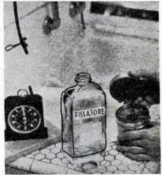
Fig. 18 - Quando il fissaggio è ultimato, togliete il coperchio, prima di versare il liquido. Potrete così assicurarvi che il processo si sia svolto regolarmente e completamente.
